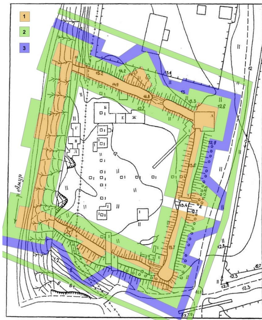
Рис. 7. Реконструкция плана крепости. Деревоземляные укрепления. 2. Земляные укрепления. 3. Ров.
